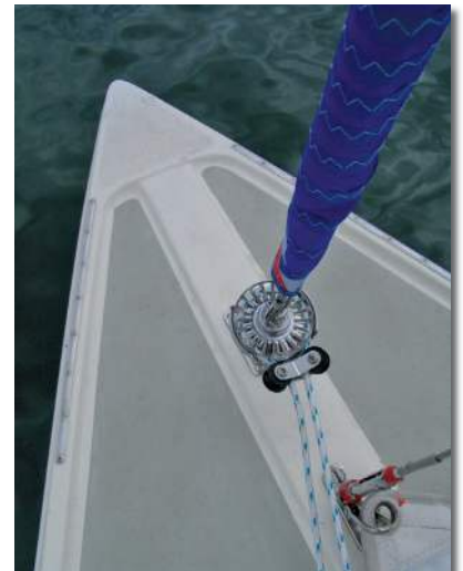
BOOSTER mit Bartels Endlos Rollanlage befestigt am Festmacherbügel am Bug.
