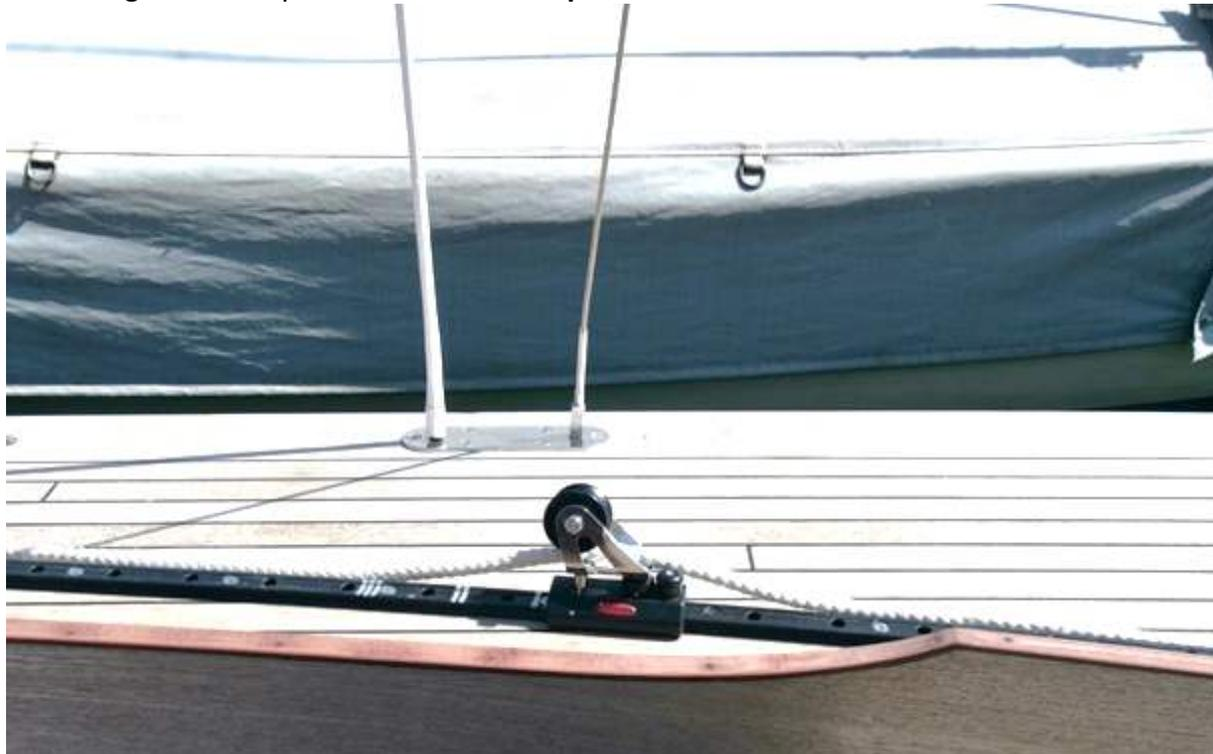
**Die Fockschot** wird bei Leichtwind so dicht gezogen, dass das Achterliek des Segels die Unterwant eben nicht berührt.
