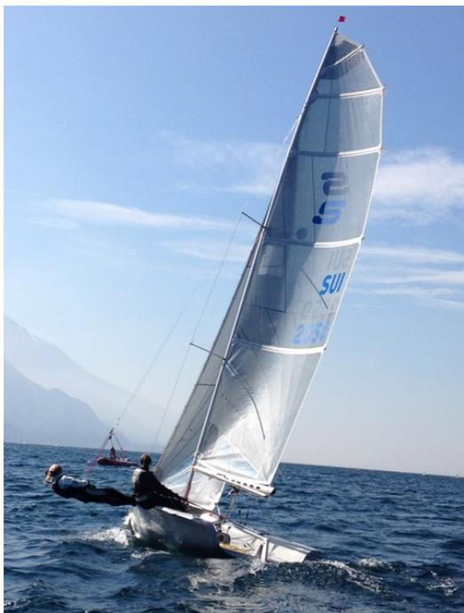
Pentex wird im Radial-Cut verarbeitet. Äußerlich ist Pentex, auch für den Fachmann, kaum von Polyester zu unterscheiden. Um die Empfindlichkeit gegen UV-Strahlung zu reduzieren, wird dem Kleber, der das Laminat zusammenhält, ein UV-Filter beigemischt, der dem Tuch ein dunkleres Aussehen verleiht.
